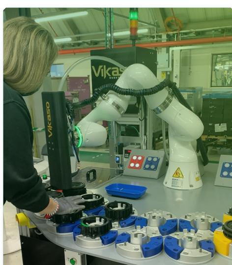
つい最近まで、ロボットのワークステーションは安全上の理由から、人間の作業員とは物理的な壁で分離されていました。しかし力覚センサーヤトルクセンサーの技術が発達したことにより、[新しいクラスの cobot](#) ではロボットアームのいづれかの部分で衝突が発生すると瞬時にこれを検知することが可能になり、傷害の可能性を減らせるようになりました。VIKASO のエンジニアリングチームのメンバーには業界をリードするロボット会社で働いた豊富な経験があるため、製造会社の視点で革新的な cobot を導入することができます。
